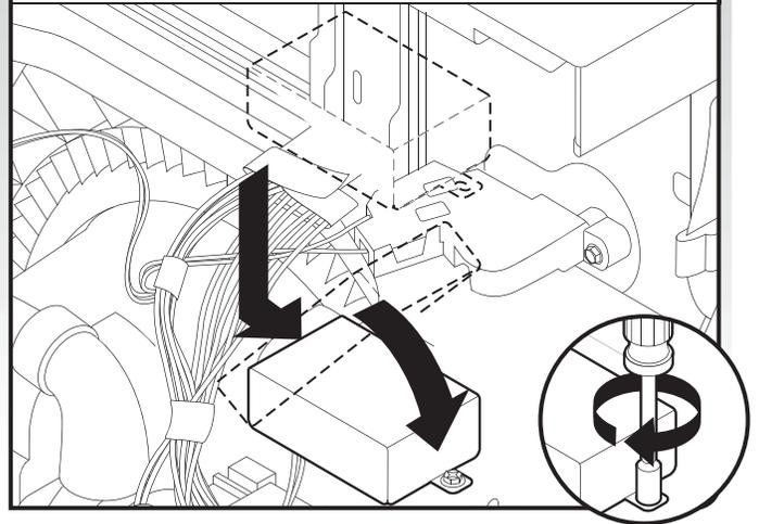
Placer les fils à l'intérieur du boîtier. Insérer les pattes du côté gauche du couvercle. Vérifier que les conducteurs sont bien engagés à l'intérieur du boîtier. Fermer le couvercle - veiller à ne pas coincer des conducteurs. Utiliser un tourne-écrou de 1/4" pour réinstaller la vis de fixation du couvercle.
